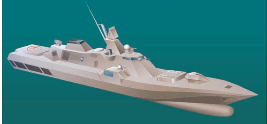
На мореходном корвете XXI века водоизмещением ок. 1300 т, концепция которого разработана Э.Х. Сертером, обводы корпуса выполнены по идеологии моделей 7Х ("вогнутое" днище; S-образная острая скула с крыльями, предотвращающими зарывание в волну). Предполагаемая скорость хода 60 уз.
