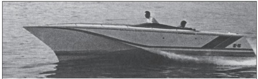
Одна из самоходных моделей Э.Х. Сертера "Е8" на испытаниях. Принцип построения обводов близок к моделям серии 7Х. Исследователь утверждает, что для катера с подобными обводами нет проблем преодоления "горба" сопротивления, нет носовой волны и брызг, отсутствует слемминг на ходу против встречной волны).
