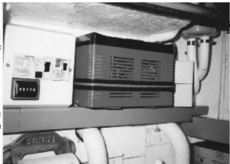
Auf der linken Seite sind der Außenlautsprecher für Netztelefon und der Typhon und die Schalter Motorraumbelüftungsgebläse Backskistenbeleuchtung Darunter die LED's der Ladekontrolle für den Dynastarter und die Öldruckkontrolle. Am
