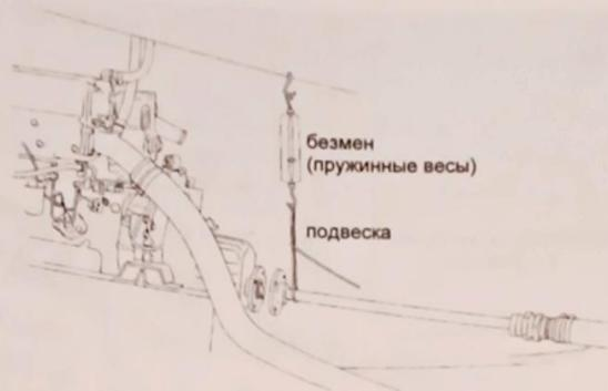
Рис. 10-20. Применение безмена для компенсации изгиба консольно закрепленного вала при регулировке положения двигателя. Натяжение подвески регулируют так, чтобы оно равнялось половине веса висящей части вала вместе с фланцем.
